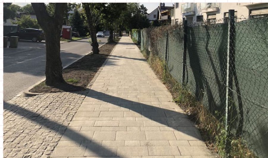
05 Kladenie kamennej dlažobnej kocky do riadku na škáru a kladenie betónovej dlažby do riadku na väzbu. Bratislava, Prokopa Velkého
