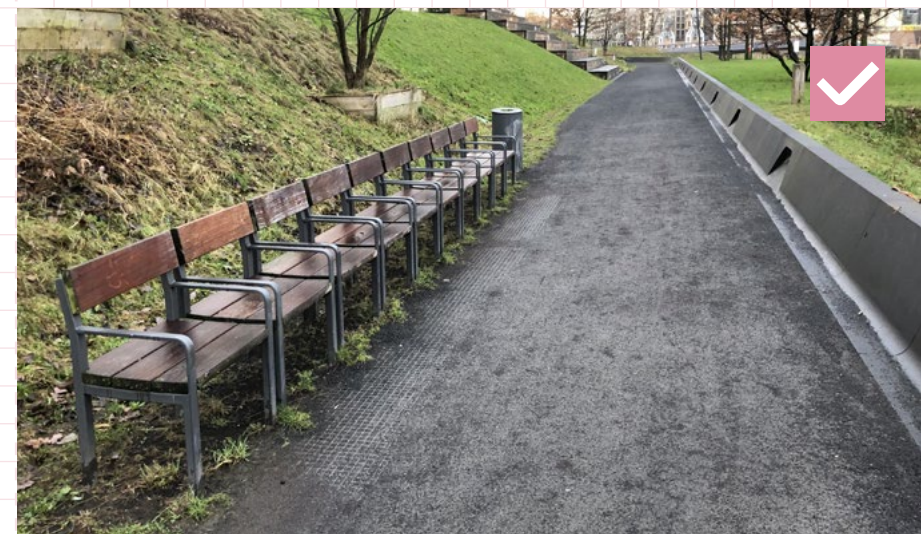
57 Mlatový povrch spevnený roštom v priestore na nohy pred lavičkou. Nemecko, Hamburg
