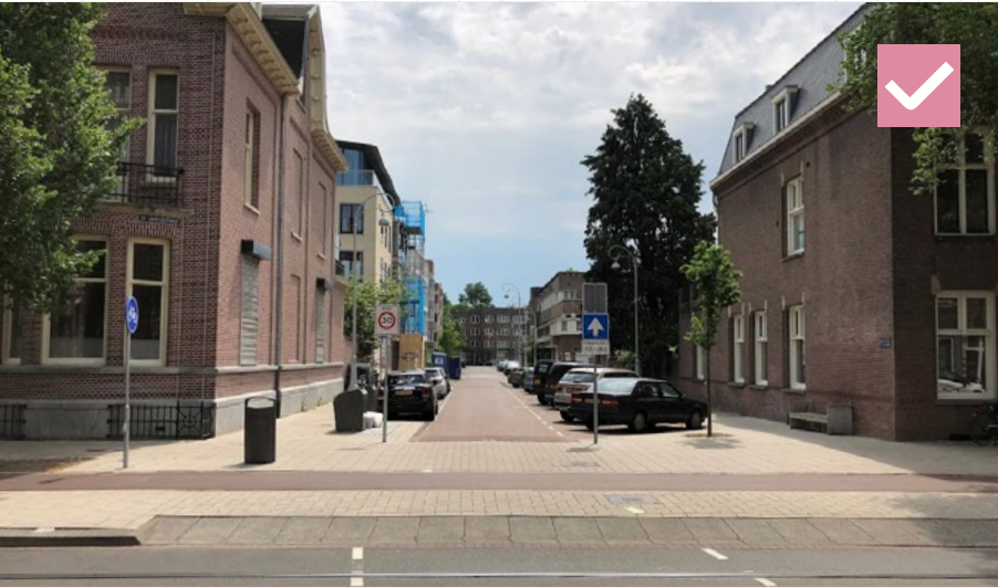
62 Priebežný chodník s cyklochodníkom s kontinuálnym povrchom na vjazde do zóny so zníženou rýchlosťou. Holandsko, Amsterdam
