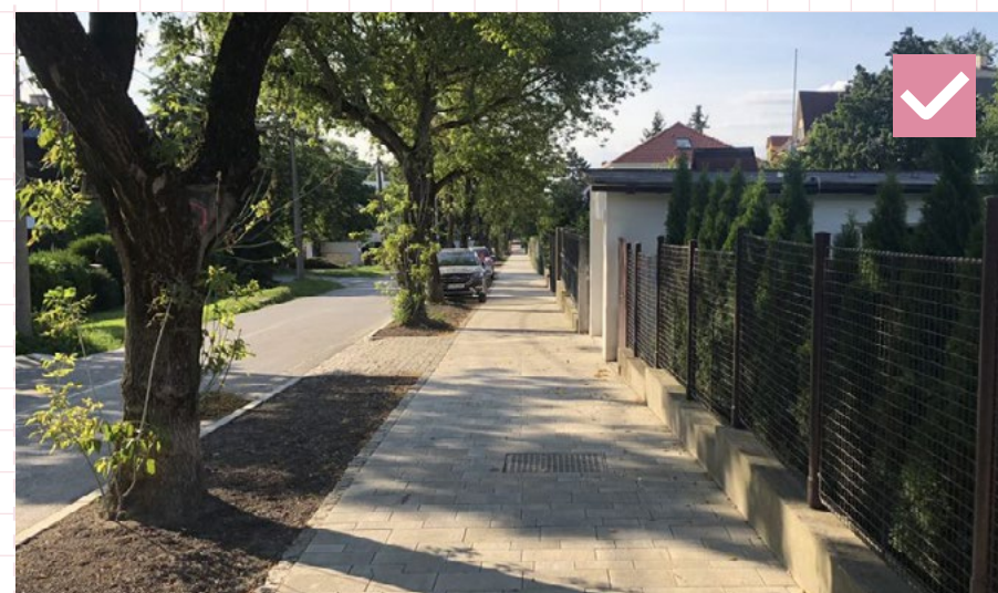
65 Zachovaná vizuálna aj úrovňová kontinuita chodníka neprerušovaná odlišným povrchom v mieste prejazdu do garáže. Bratislava, Prokopa Veľkého
