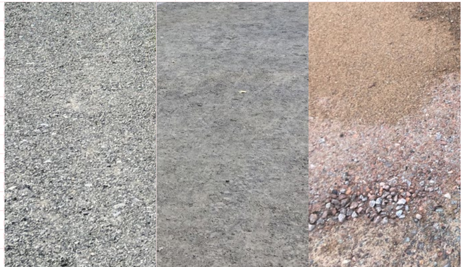
Zľava drvené kamenivo, jemné drvené kamenivo, kamenivo rôznych frakcií (vrstvy mlatového povrchu).
